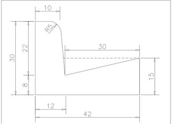
**DET. 03 - MEIO FIO C/ SARJETA SEM ESC**
