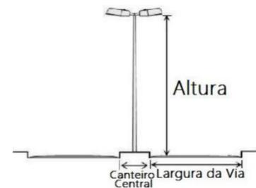
5.4 Este tipo de posicionamento, com duas luminárias instaladas em um único apoio, é normalmente usado em vias com canteiro central estreito.
