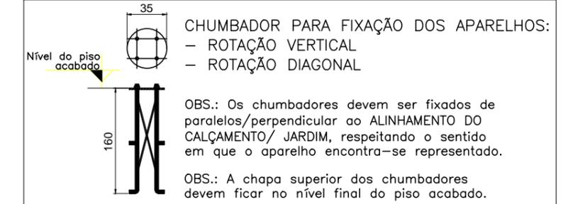
EQUIPAMENTOS FIXADOS COM PARABOLT
