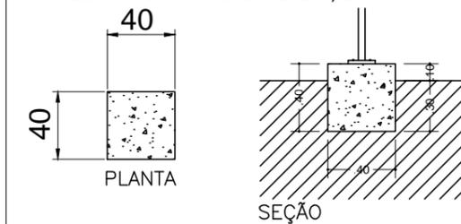
DETALHES DA ESTACA DE CONCRETO
