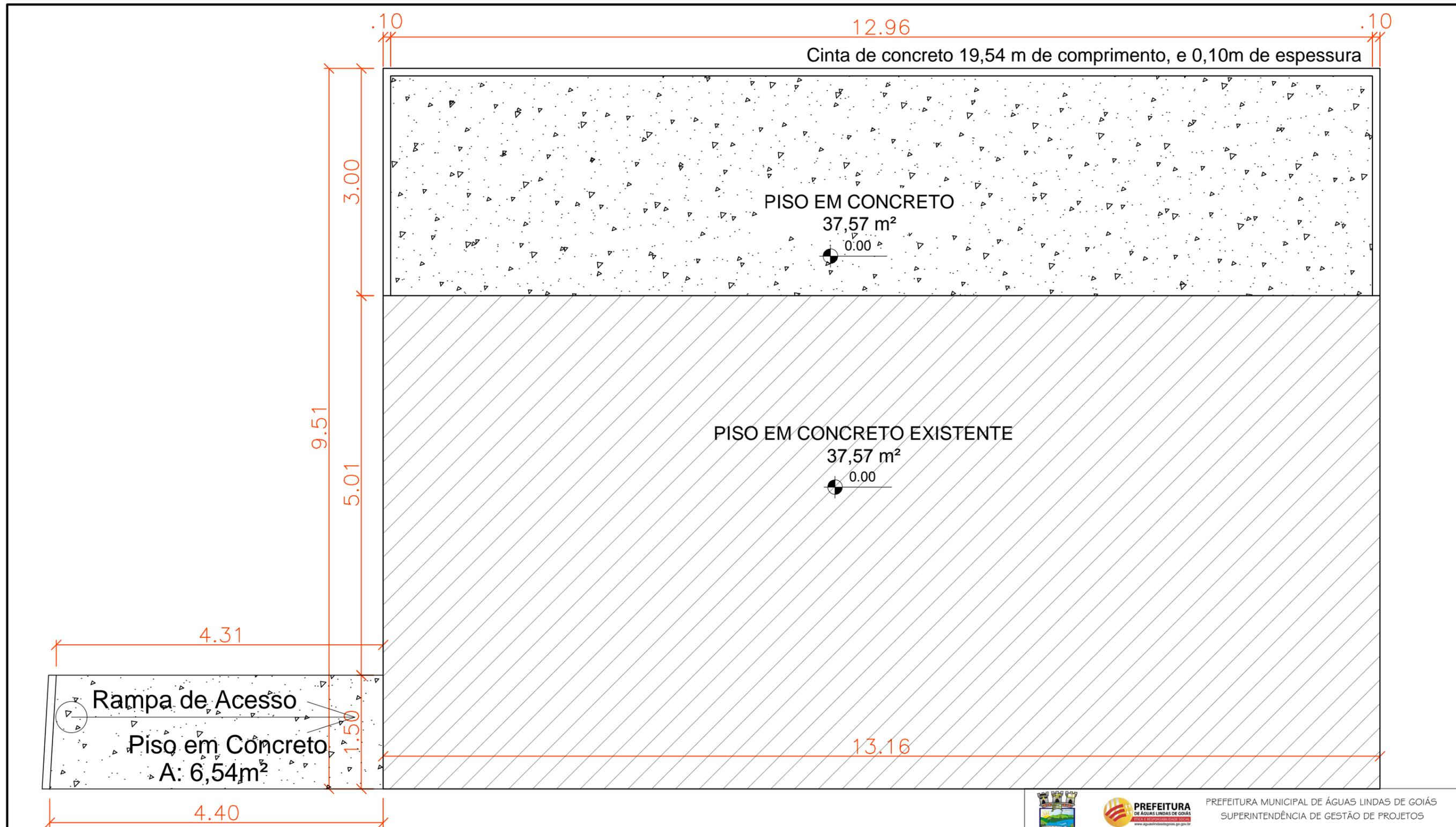
PLANTA BAIXA - PISO EM CONCRETO A CONSTRUIR
