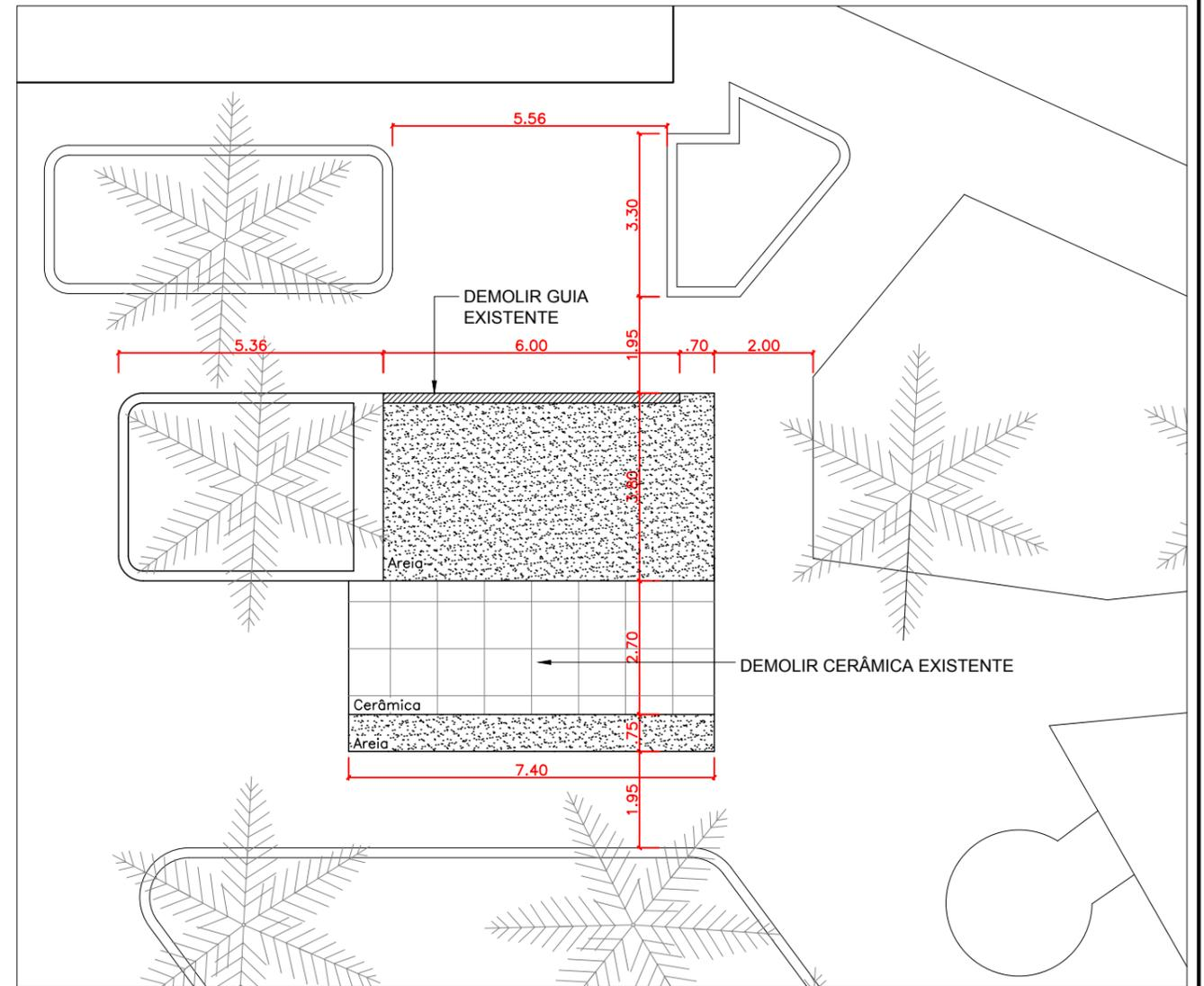
PLANTA DE DEMOLIÇÃO
