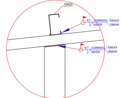
**LIGAÇÕES SOLDADAS EM ESTRUTURA METÁLICA**
